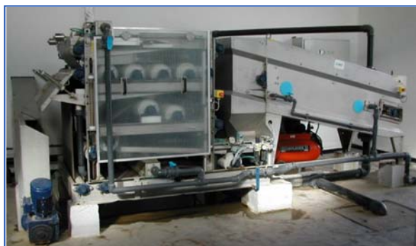
Гравитационный ленточный сгуститель, объединенный с ленточным фильтр-прессом
